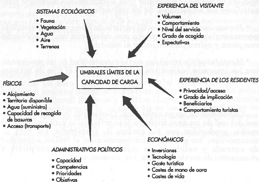
Figura 26 Factores que limitan la capacidad de carga
